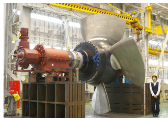
チューブラポンプ回転体(口径4,200mm)
