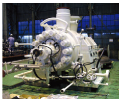
ボイラ給水ポンプ
