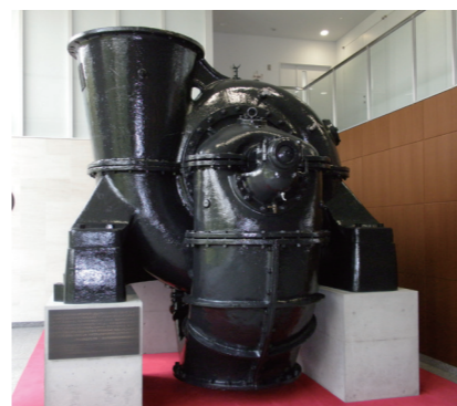
東京都浅草田町ポンプ所で使用された大型渦巻きポンプ
