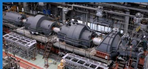
石油精製・石油化学プラントの心臓部として、原油、天然ガスから発生するガスの圧縮工程に使用されます。お客様のニーズや各プロセスに対応する幅広いラインナップを用意しています。
